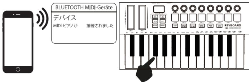
MIDI キーボードをオンにして (Bluetooth 機能は自動的にオンになります)、「GarageBand」などの Bluetooth MIDI 操作をサポートする DAW アプリを開きます。アプリ設定または詳細機能から「MIDI ピアノ」を検索して接続します。キーボードのキーのいずれかを押すと、デバイスが正常に接続されたことを示す音が聞こえます。
